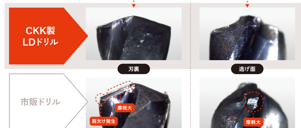
60m切削完了後の刃先摩耗比較
